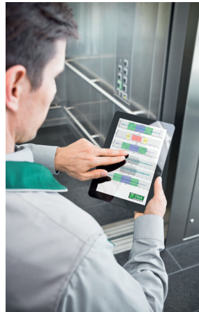
Prestandamätning vid återkommande besiktning av en hiss
